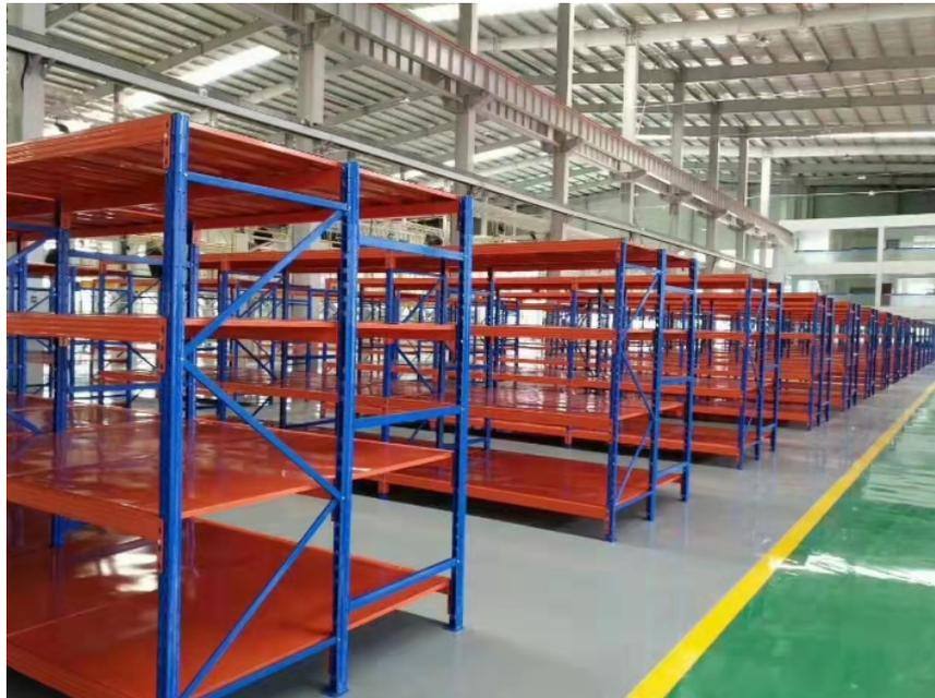
横梁货架具有惯性矩大、层载能力强、抗冲击性能强的特点，每层较大层载在相对设计下可达5000kg/层。可塑型非常大，在托盘货架基础上搭建模具货架、阁楼货架、立体库货架等还可做成特殊的油桶货架等。横梁货架可有效的提高仓库存储高度，提高仓库的空间使用率。适合各类型货品存放。外形安全，防止叉车碰撞还可以增加立柱护脚、防撞杆。为了层载更安全还可在横梁上安置横梁搁挡、层板、网片跨梁等附属设施。造价成本低，安装操作方便，查找货位容易适用于任何搬运工具。横梁货架还可以配层板，可以是钢板、，密氨板或格栅网。以便使用不同尺寸的托盘。汕尾轻型仓储货架报价按货物储存货物单元的型式分类，又可分为托盘货架和容器货架。
