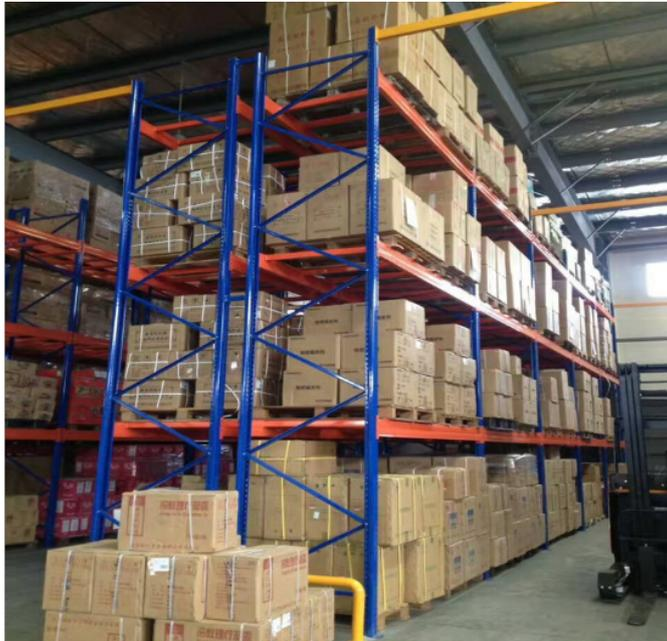
货架的检查：检查所有存放货物的尺寸和类型是否合适；检查外观的配置是否与原实际一致；检查货架的变形量；检查安全销是否完整，有无损坏，避免安全事故的发生；要检查货架的横梁，搁挡，及附件是否损坏，校正立柱的直线度；检查托盘货物的重量；检查固定立柱的地面膨胀螺栓是否松动；检查护脚和其他保护措施；检查地面是否下沉或损坏的情况；检查人员要根据实际情况如实记录，并向部门负责人递交书面的检查结果，派遣专业的货架人员对隐患进行排除。重型横梁式货架一般情况下，立柱高度不超过18米，并可在货架基础上搭建平台货架。河源物流仓储货架厂家直销
